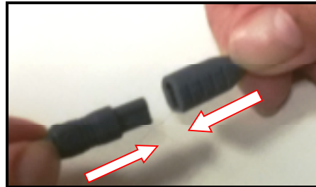
Abbildung 5: Verbindung von Aktuorkabel und Treiberkabel
